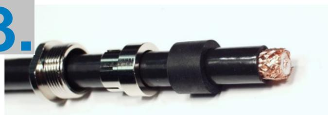
Mit einem Messer 6 ... 7 mm des PVC-Mantels entfernen.
