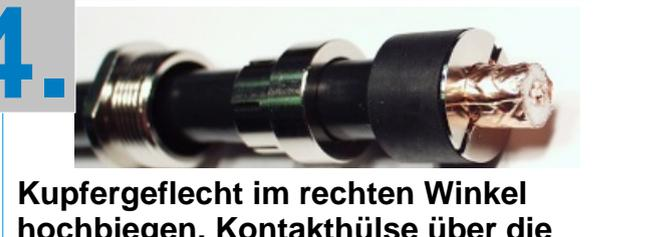
Kupfergeflecht im rechten Winkel hochbiegen. Kontakthülse über die Kupferfolie bis zum Anschlag unter den PVC-Mantel schieben. Überstehendes Geflecht abschneiden. Gummidichtung bis zur Kontakthülse nach vorne schieben.
