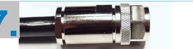
Das so vorbereitete Kabelende bis zum Anschlag in das Steckergehäuse einschieben. Mit einem 17 mm bzw. 18 mm Maulschlüssel die Spannmutter handfest anziehen. Ein kleiner Spalt zwischen Mutter und Steckergehäuse sollte noch sichtbar sein!
